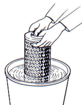
Fig. 3-5 Limpieza del elemento filtrante
