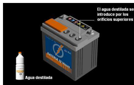
Fig. 6-4 Adicción de agua
