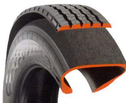
Fig. 8-17 Aplicación de una nueva banda
