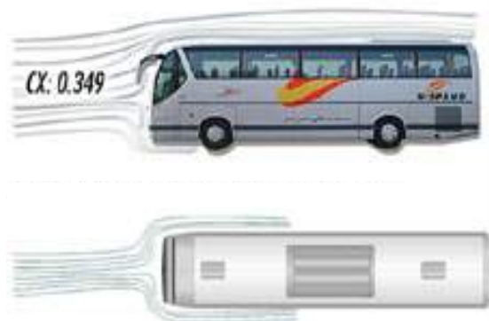
Fig. 1-12 Cálculo del coeficiente C_x
