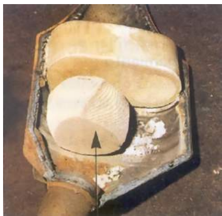
Fig. 4-11 Desgaste y rotura del catalizador
