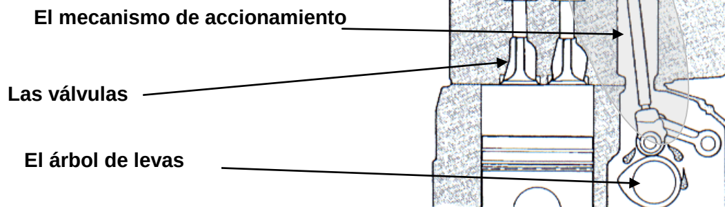
Fig. 2-10 Sistema de distribución
