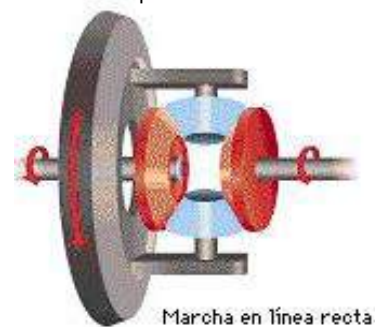
Fig. 7-25 Corona y los dos planetarios giran lo mismo
